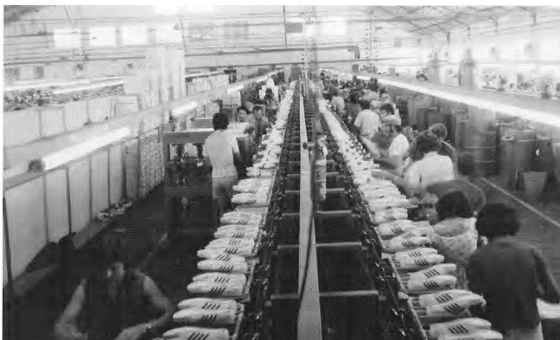
Figura 3 Fabricação de calçados utilizando trilhos
