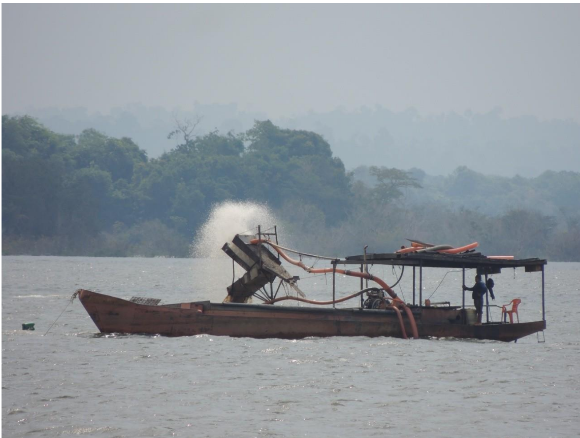
Draga em funcionamento extraíndo areia do Rio Xingu.
