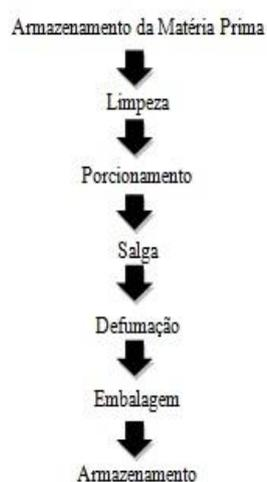
**Figura 1** Fluxograma do processamento de filé de tilápia defumado.
