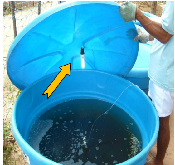
FIGURA 4: Caixa d'água mostrando a lâmpada fluorescente de 11W na tampa.
