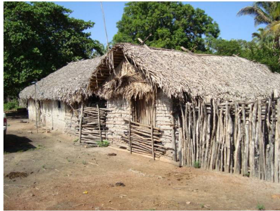
Figura 3 - Casa construída com cobertura de palha de babaçu ( Attalea speciosa Mart. ex Spreng.) em comunidade extrativista de Esperantina, PI, Brasil.
