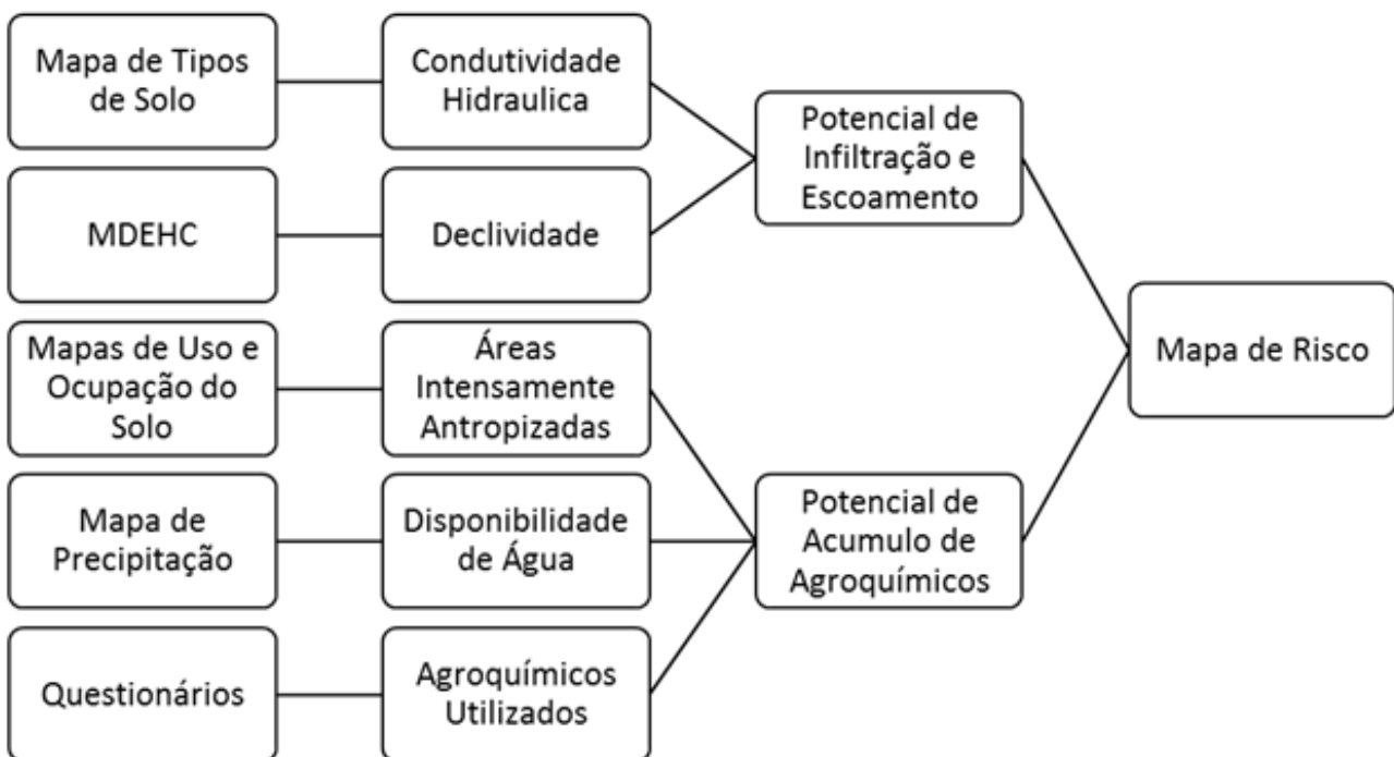
Figura 2. Fluxograma para a produção da carta de risco. Adaptado de Neves et al. (1998).
