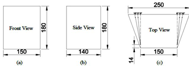
Fig. 4 Diffuser dimensions.
