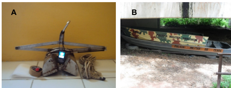
Figura 2 – (A) Draga de Van Veen, GPS e sacos Plásticos para acondicionamento de sedimentos, (B) Barco da Companhia de Polícia Militar Ambiental (julho de 2011).
