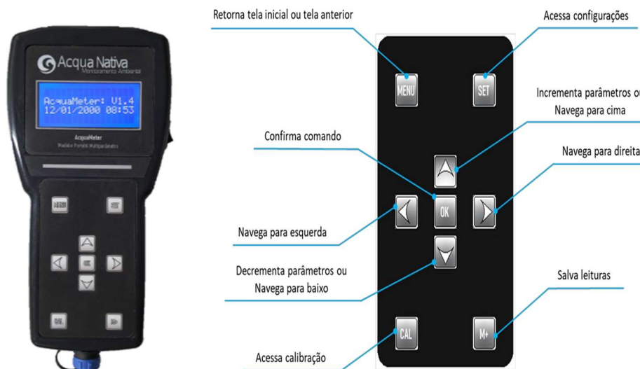
Figura 3. Sonda Multiparâmetro AcquaMeter – AP3.
