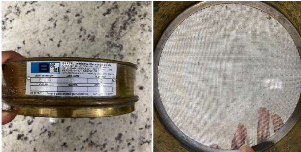
Figura 6: Peneira geológica utilizada para extração da macrofauna
