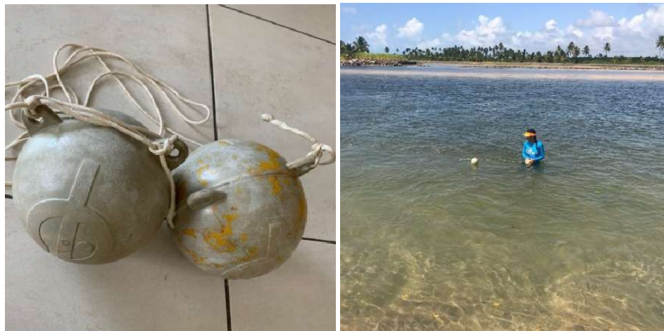
Figura 4: (a) Flutuador usado para aferição da deriva litorânea; (b) local que foi posicionado o flutuador
