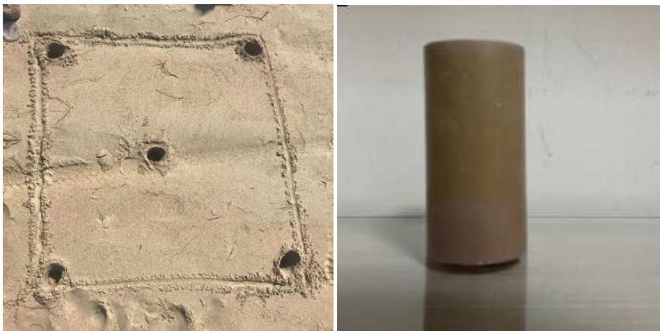
Figura 03. Marcação para coleta do material sedimentar e testemunho em PVC
