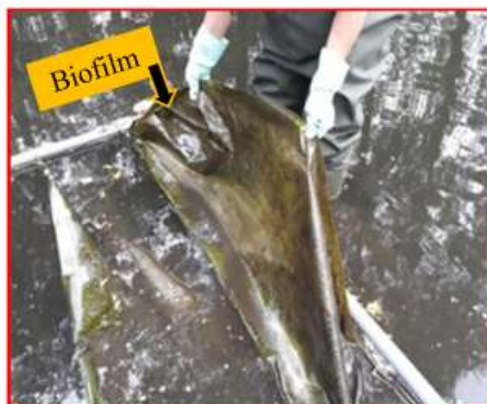
Figura 4. Biofilme aderido aos plásticos da estrutura de biorremediação em 15 dias de experimento.
