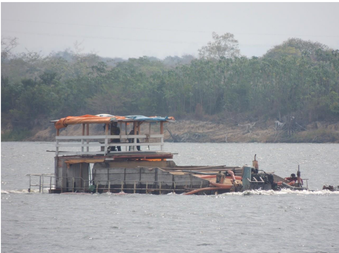
Draga utilizada na retirada de areia.
