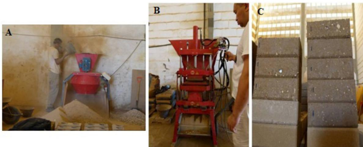
Para a elaboração dos tijolos foram utilizadas três porcentagens de conchas (30, 50 e 60%), cimento e argila de escavação de subsolo extraída das áreas de construção de prédios. As amostras foram elaboradas utilizando as seguintes proporções de materiais (Tabela 1).
