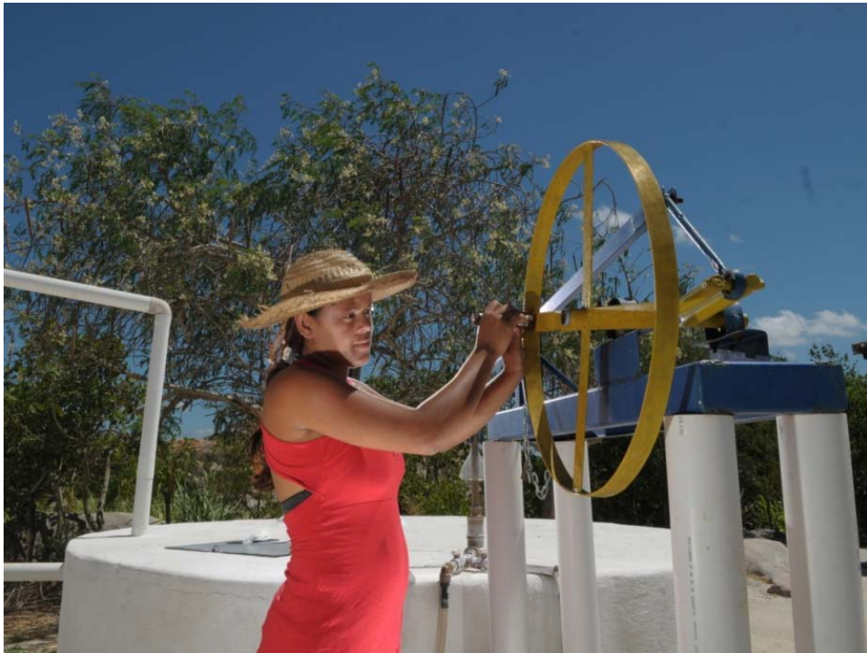
Figura 4 – Cisterna de placa com auxílio da bomba aro-trampolim.
