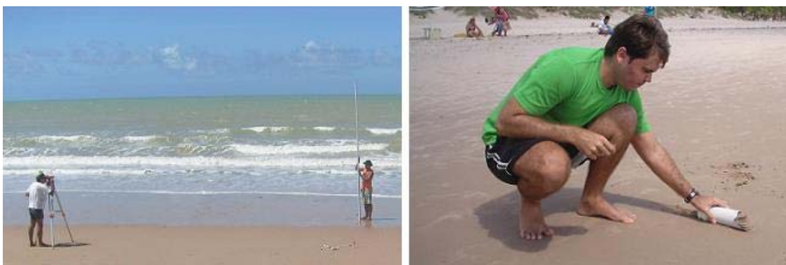
Figura 2 – Nivelamento topográfico (A) e coleta de sedimentos (B).
