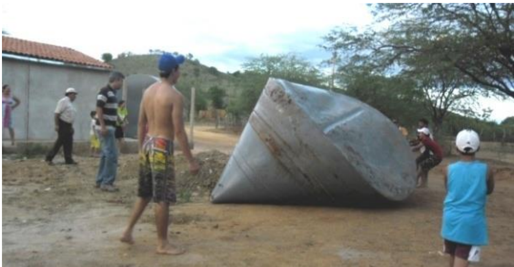
Imagem 03: cisterna de polietileno deformada em virtude das elevadas temperaturas.
