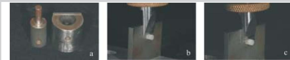
**Figura 2** - Dispositivos de carregamento para a realização do teste de cisalhamento: a) pistão; b) cinzel reto; c) cinzel reto com entalhe.
