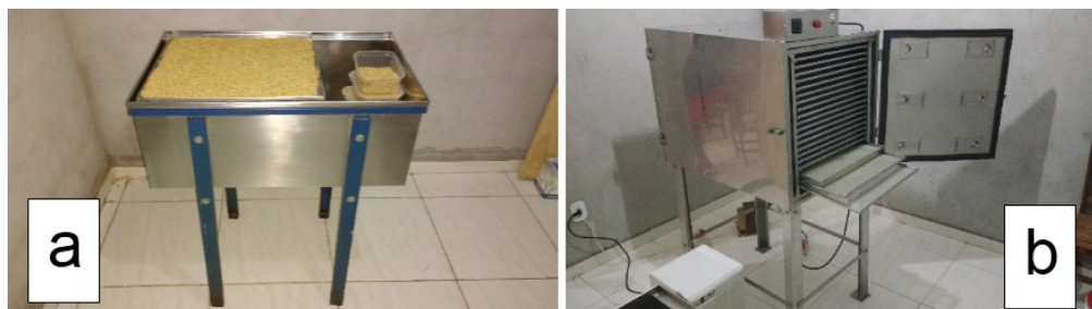
Figura 2. (a) Pólen apícola distribuído em fina camada em gaveta telada para desidratação; (b) modelo de estufa com 20 bandejas em aço inoxidável.
