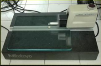
Rugosímetro portátil (Mitutoyo SJ 201P); foram realizadas três mensurações por amostra, por uma distância de 3 mm e velocidade de 0,1mm/seg.
