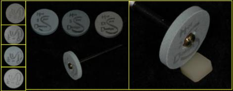
Fig. 5: Polimento com pontas de borracha.
