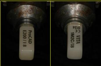
Fig. 3: Blocos cerâmicos medindo 15x7x7mm (PxAxL).
