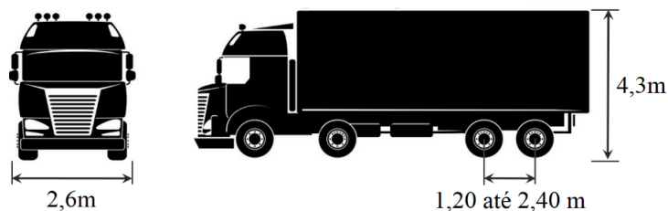
Figura 4: Representação esquemática dos comprimentos máximos definidos pelo Mercosul
