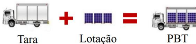
Figura 3: Representação do Peso Bruto Total (PBT) de um veículo.
