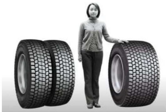
Figura 4: Comparação entre rodagem dupla com pneus normais (esquerda) e rodagem com pneus extralargos (direita)
