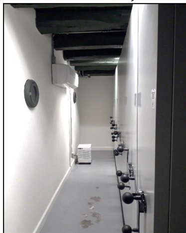
Figura 3 - Estantes de aço deslizantes
