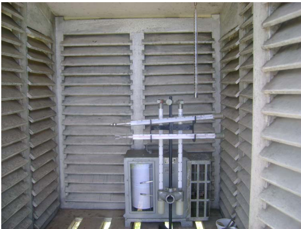
Figura 1 – Psicrômetro ordinário da Estação Climatológica da UFRN Fonte: Juliana Costa, 2008.
