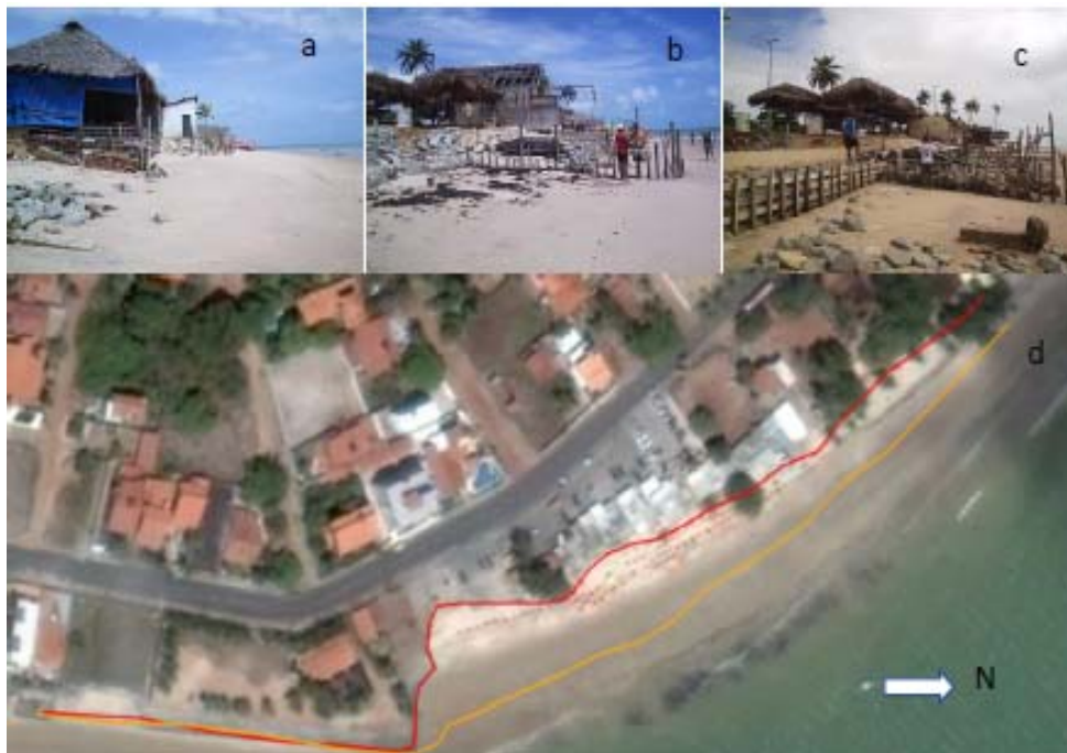
Figura 10. Praia Ponta do Seixas, litoral sul de João Pessoa PB; (PO=10) Localização: 07° 09' 21" LS; 34° 47' 36" LO;. (a) 1999; (b) agosto/2006; (c) outubro/2006; (d) 2016. As linhas coloridas foram delimitadas respeitando os pontos da linha de costa considerando como referência a linha de estruturas artificiais de engenharia (bares, casas). Foram utilizadas imagens do Google Earth dos anos de 2005 (linha cor de laranja) e 2016 (linha vermelha).
