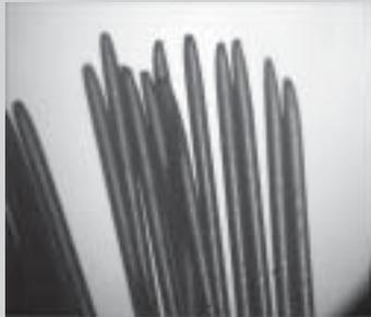
Figura 1e- Todas as cerdas arredondadas e ausência de farpas.
