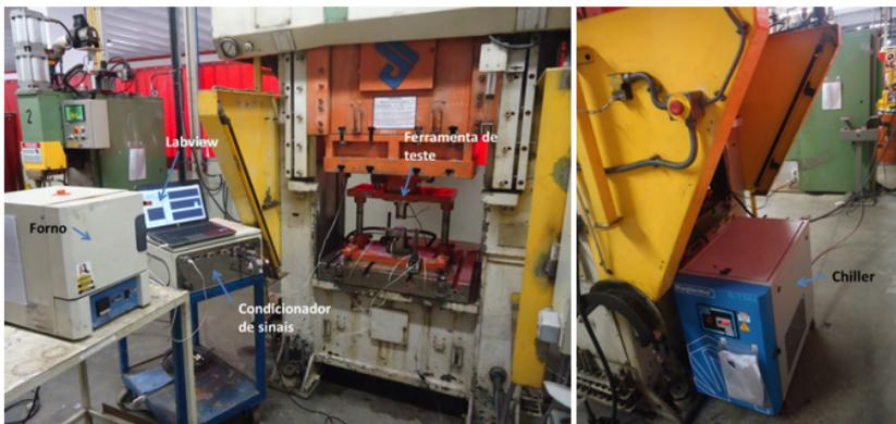
Neste estudo foi priorizada a aplicação de diferentes temperaturas do fluido nos canais de refrigeração, a fim de analisar a taxa de resfriamento obtida durante o processo e sua influência na dureza e microestrutura do material. A Tabela 2 resume os parâmetros do processo empregados neste estudo.
